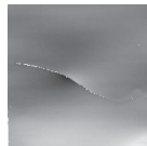
Solarzelle mit Bruch
